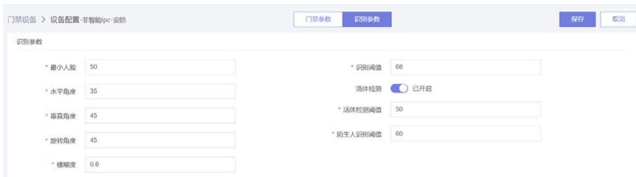
图 4.2-15 网络摄像机/智能摄像头-识别参数配置
