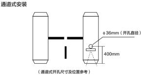
固定:把人脸识别设备安装在闸机的孔位上,并旋转到合适角度,将固定螺母拧紧。
