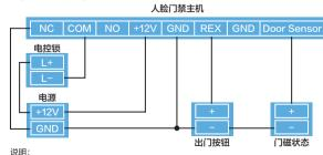
此设备作为独立的门禁主机对接电锁和出门按钮,确保12V电源的功率满足设备和电控锁。 门禁控制器接法
